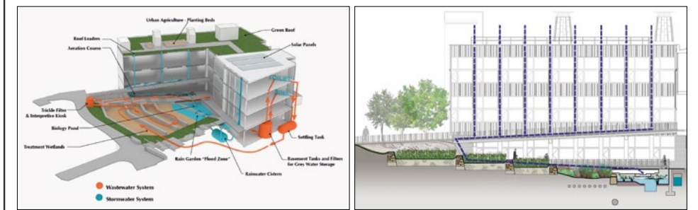
2. Schema di funzionamento del ciclo di recupero delle acque piovane e di scarico 3. Sistema di depurazione delle acque piovane prima dell'immissione nello stagno
